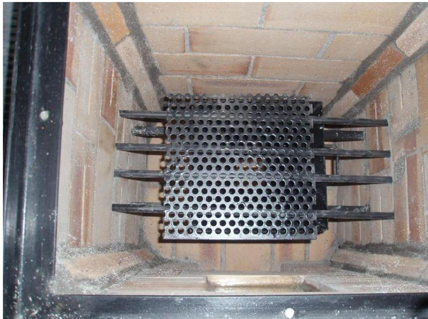
d) Parte superior del horno. Se construyó una estructura metálica donde colocar los ladrillos refractarios
