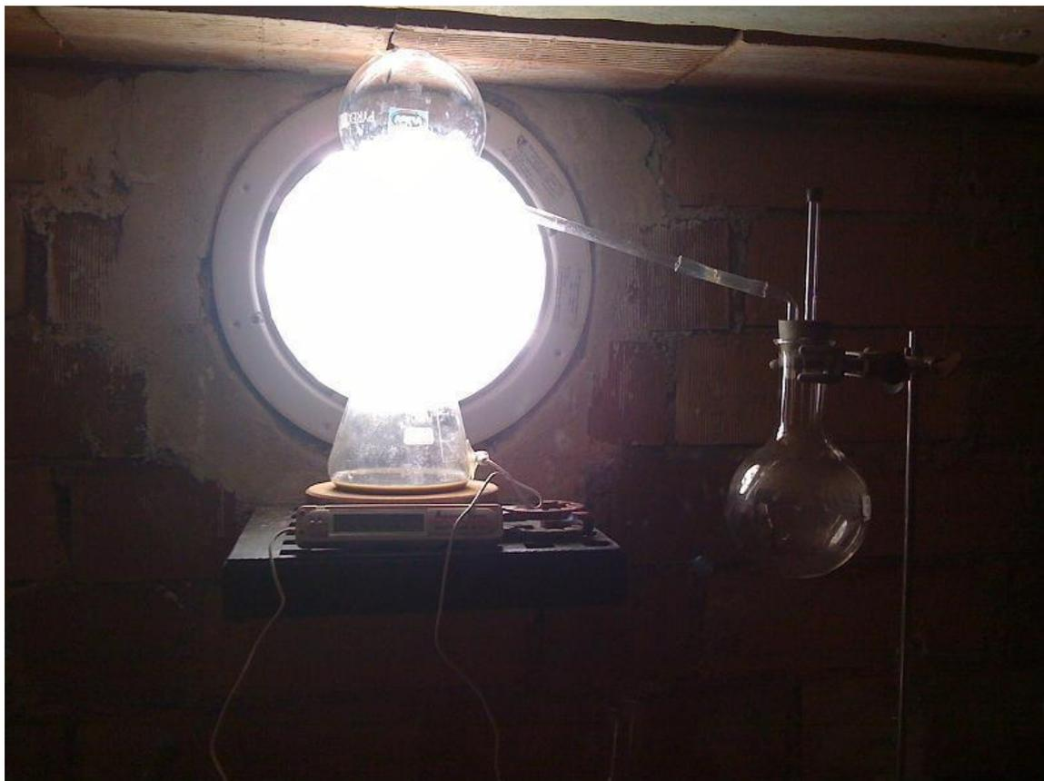
Ilustración 103 Destilador solar, luz fría.
