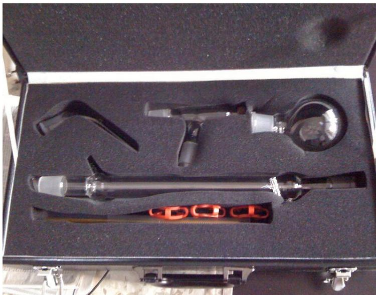
Ilustración 64 Destilador Simple.
