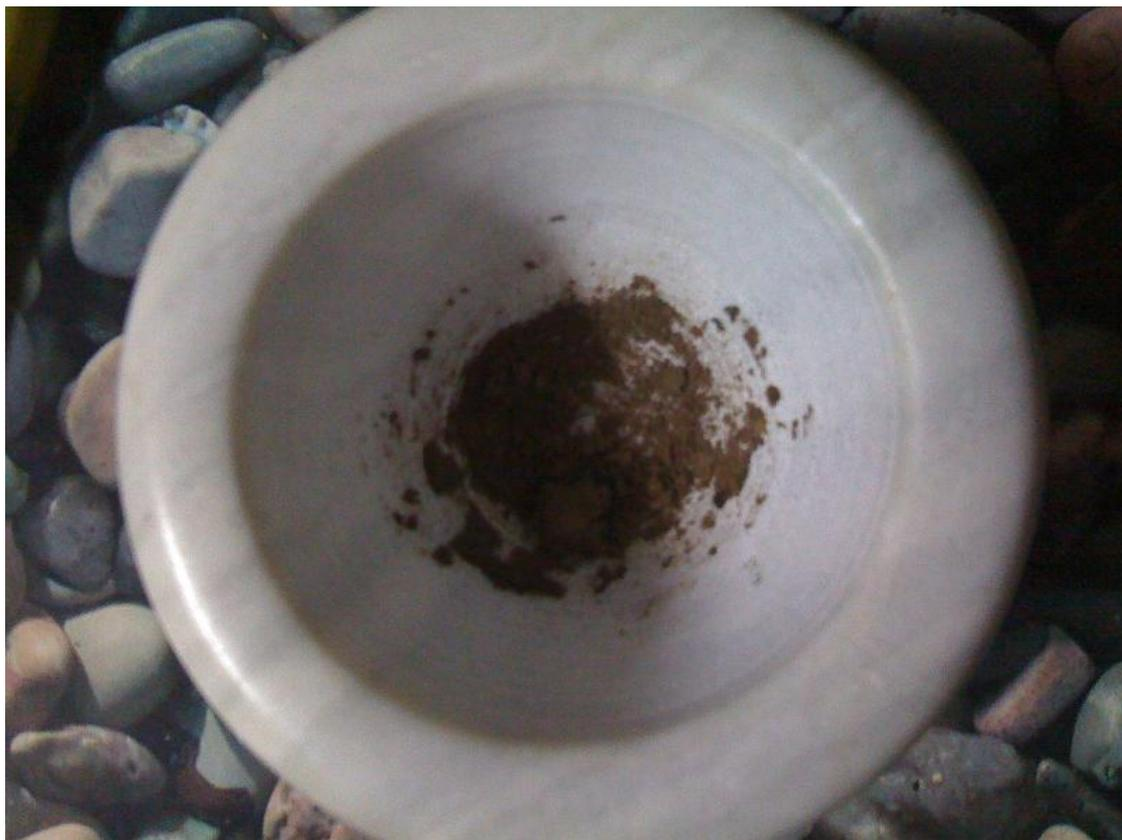
Ilustración 75 Foto de tierra seca pulverizada por el mortero.
