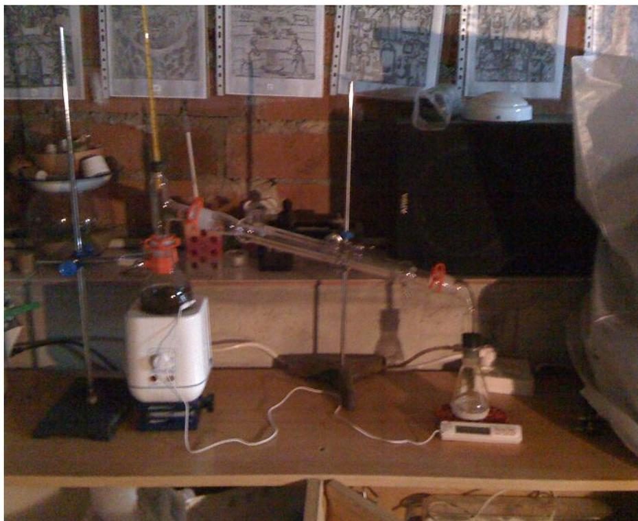
Ilustración 65 Destilador Simple Montado.
